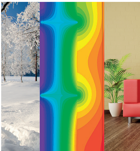
Imagem 1 Ponte térmica pronunciada em consoles de alumínio
